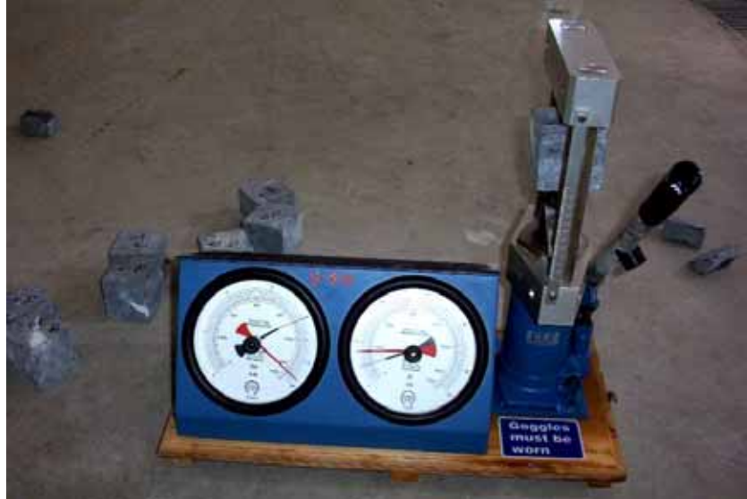
Şekil 8. Nokta yük deney cihazında dayanım indeksi tayini
