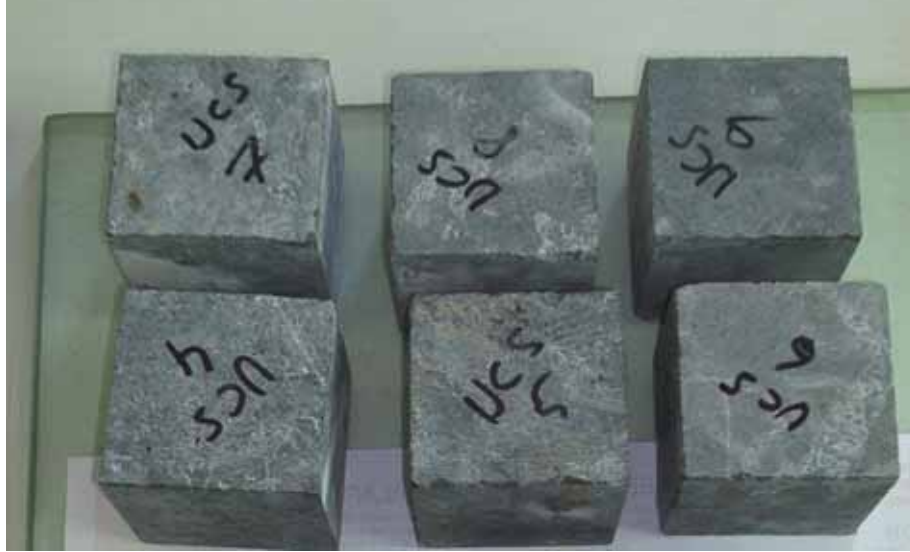
Şekil 5. Sahada alınan numunelerin standartlara uygun olarak 7x7x7cm boyutunda hazırlanması
