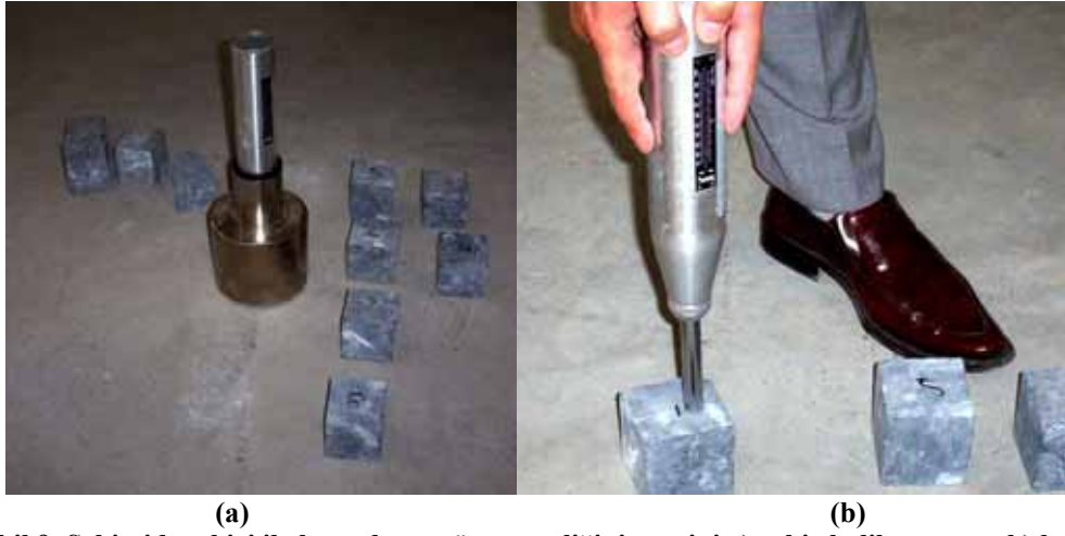
Şekil 9. Schmidt çekici ile kayaların yüzey sertliğinin tayini a) çekiç kalibrasyonu, b) kayac sertliğinin ölçülmesi
