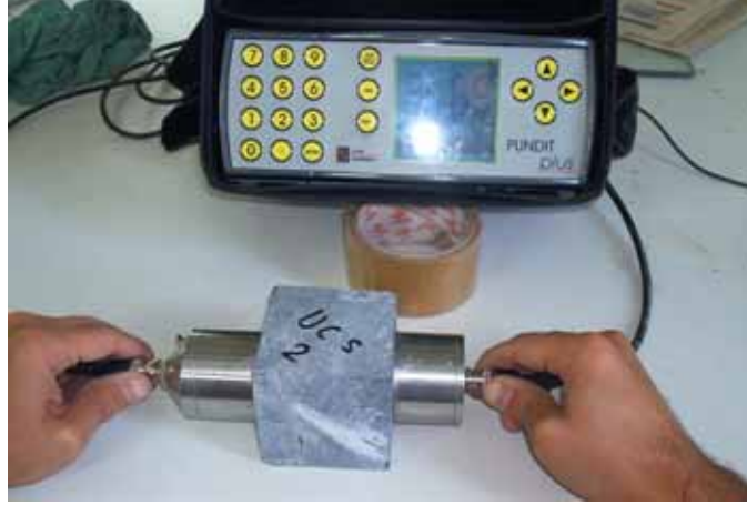
Şekil 7. Pundit plus CNS Farnell cihazı ile kaya numunesinde sonik hız (P-dalga) tayini
