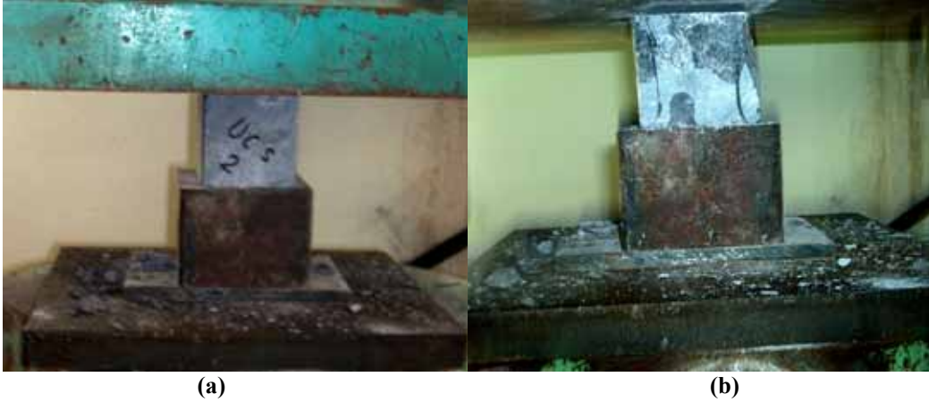
Şekil 6. Tek eksenli sıkışma dayanımı altında kaya numunesinin davranışı a) yenilmeden önce b) yenilmeden sonra
